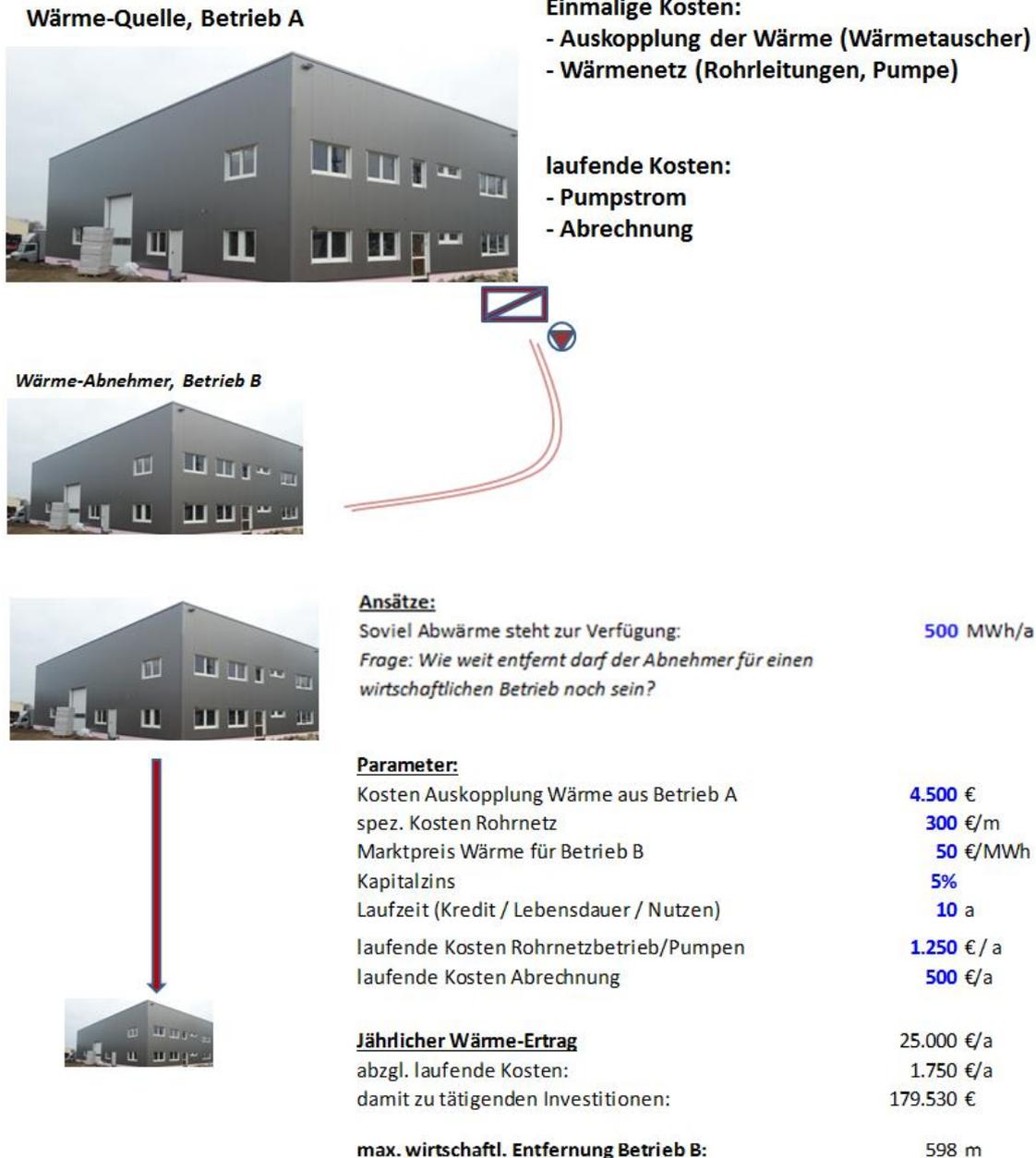
Abb. 95: Abschätzung der Wärmetransportentfernung bei Abwärmeüberschuss
