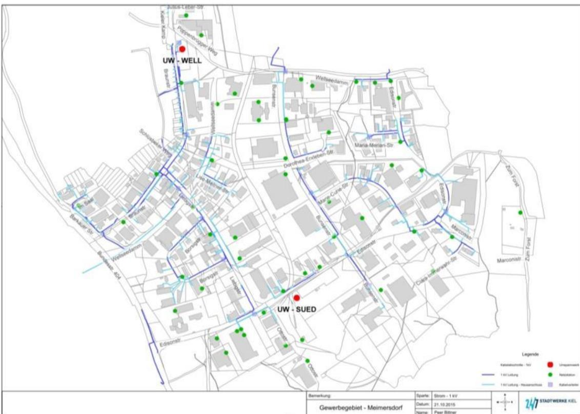
Abb. 19: Netzinfrastruktur 1 kV-Leitungen inkl. Hausanschlüssen, Umspannwerken, Netzstationen und Kabelverteilern im Gewerbegebiet Kiel-Wellsee
