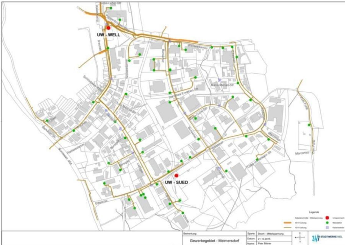
Abb. 18: Mittelspannungsnetz (30 kV- und 10 kV-Leitungen) inkl. Umspannwerken, Netzstationen und Kabelverteilern im Gewerbegebiet Kiel-Wellsee
